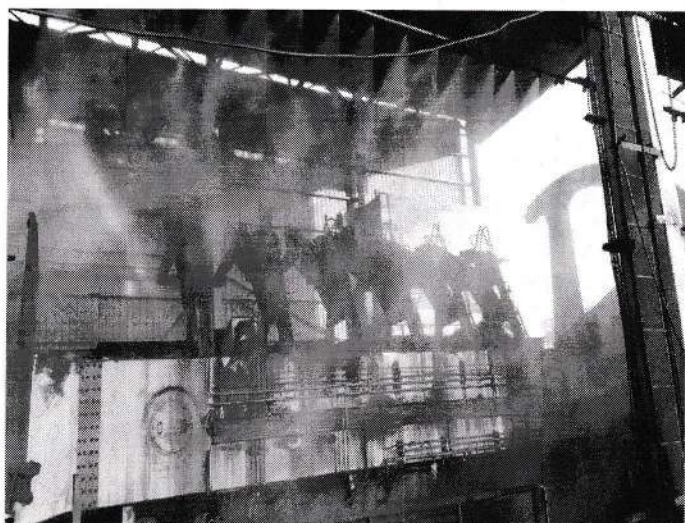
(Wagon Tippler: Dry Fog Dust Suppression System)
